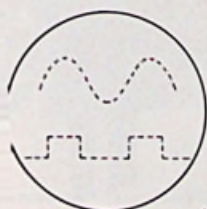
g.1 TWEE SIGNALEN ZICHTBAAR GEMAAKT MET EEN SIMULTAANSCHAKELAAR
